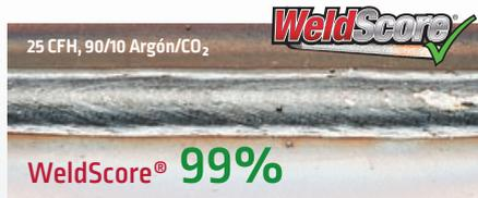
Cordón de soldadura aceptable: Un caudal de gas de protección adecuados producen una buena soldadura sin poros.
