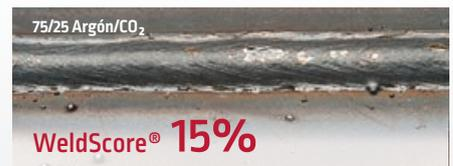
Cordón de soldadura rechazable: Una mezcla de gas incorrecta genera altos niveles de proyecciones.
