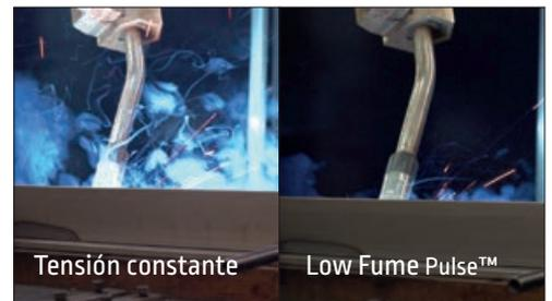
\* Reducción del 66 % de los humos generados [gramos/minuto] con un hilo de 1,32mm pulgadas a 1metro por minuto y manteniendo constante el gas, diámetro del hilo, velocidad de hilo y la punta de contacto para trabajo a distancia.
